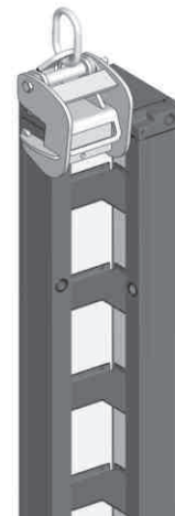
Bei Elementbreiten von 30 cm und kleiner sowie bei Innenecken ist die Anbringung des MST Kranhakens wie dargestellt zulässig.
